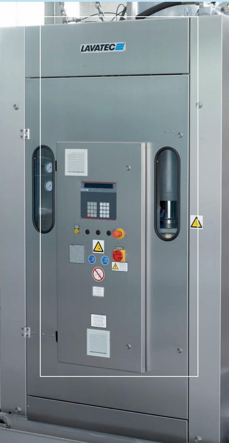
„Die Lavatec Presse sorgt für eine optimale Entwässerung der Wäsche und damit zu einer kürzeren Laufzeit der nachgestellten Trockner.“
