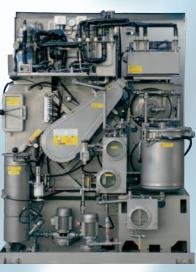
Mit VARIO-SPEED sind Reinigungsdrehzahlen von 18 bis zu 50 U/min programmier-
